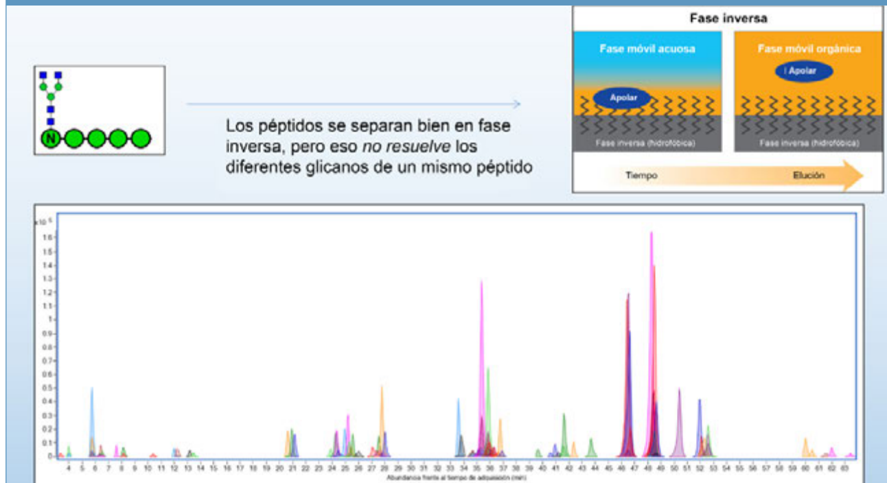
FIGURA 2: Separación de glicopéptidos en fase inversa.
